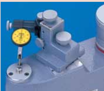
Calibrando un indicador de carátula tipo palanca
